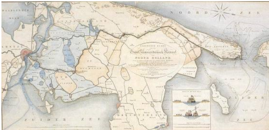
Figuur 21: Het Noordhollands Kanaal dat in het begin van de negentiende eeuw werd gegraven naar ontwerp van Jan Blanken Jansz. Het kanaal heeft maar korte tijd als verbinding tussen Amsterdam en de zee dienst gedaan. Belangrijke redenen voor de aanleg van dit tracé waren: (1) de noodzaak om Amsterdam beter bereikbaar te maken door de zandbank Pampus voor de ingang van het IJ; (2) de angst om een rechtstreekse verbinding door de duinen te graven en (3) de rechtstreekse verbinding die ontstond tussen de hoofdstad en de marinehaven van Nederland. (Bron: Borger & Bruines, 1994).
